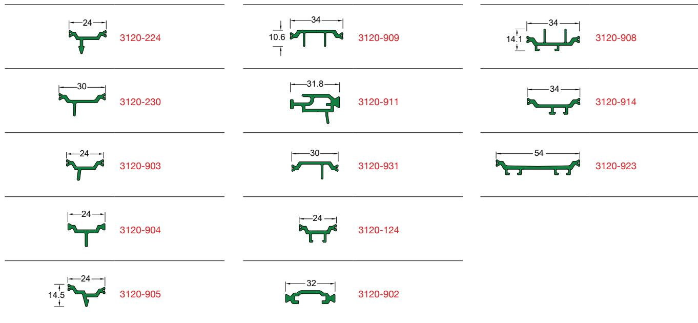
Material/Υλικό: PA66 GF25, Length/Μήκος: 6 m, Pack/Δέμα: 10 Bars/Βέργες
