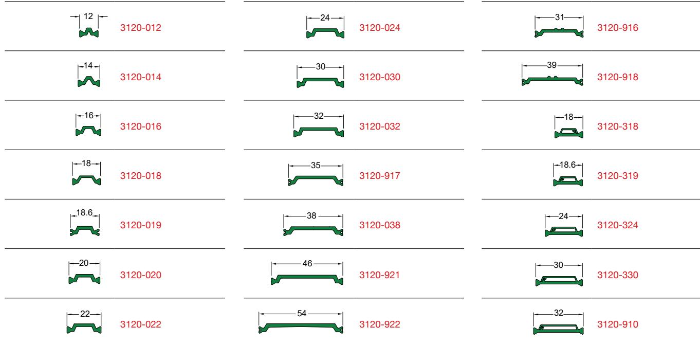
Material/Υλικό: PA66 GF25, Length/Μήκος: 6 m, Pack/Δέμα: 10 Bars/Βέργες
